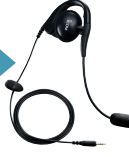
HS-94 Öronmussla med bom-mikrofon
